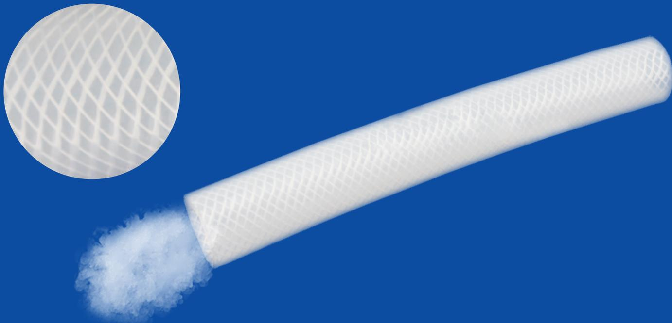
**应用：**在食品和制药行业 用于在低压和较大弯曲半径的条件下传输液体。物料输送的理想软管。软管可补偿振动和消除位差。不可用于负压条件。
